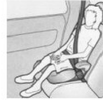
Sitzerhöhung ohne Rückenlehne, Sicherung mit 3-Punkt-Gurt (Erwachsenengurt) (Gruppe II-III)
