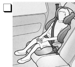
Sitzerhöhung mit Rückenlehne, Sicherung mit 3-Punkt-Gurt (Erwachsenengurt) (Gruppe II-III)
