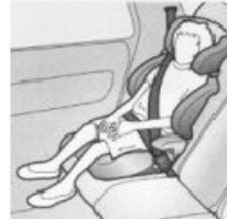
Sitzerhöhung mit Rückenlehne, Sicherung mit 3-Punkt-Gurt (Erwachsenengurt) (Gruppe II-III)
