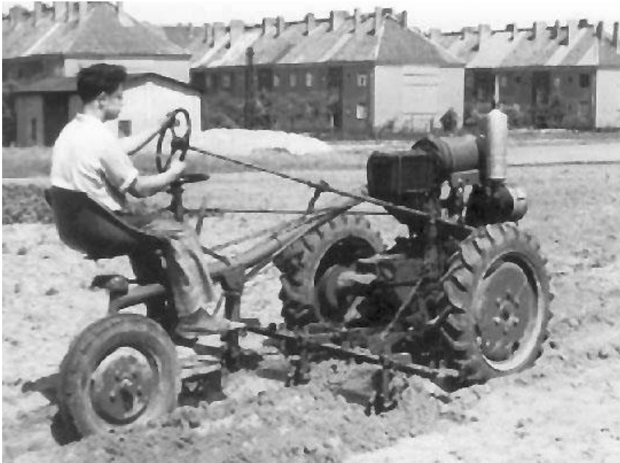
Bild 4: Von Marks und Heidemann entwickelter Schwenkarm-Kleinschlepper (1952)
