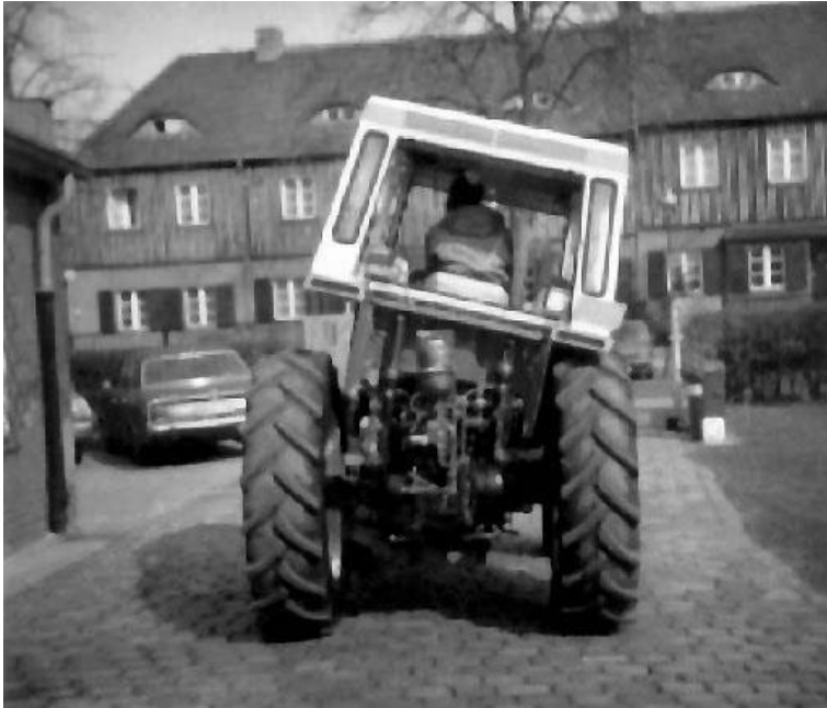
Bild 111: Gefederte Traktorkabine mit Hangausgleich (1980)
