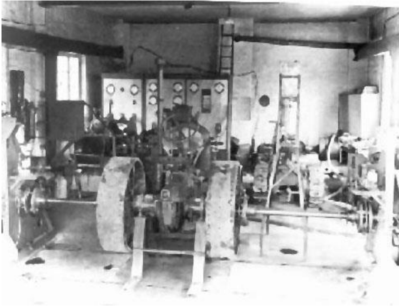
Bild 6: Traktor-Bremsprüfstand im Versuchslaboratorium 1926
