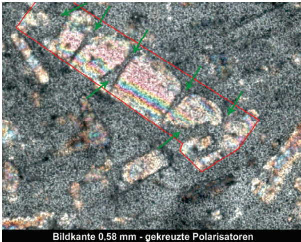
Abb. 10: Ala_K_For_003 großer säuliger Anhydritkristall bereits an mehreren Stellen in Gips umgewandelt
