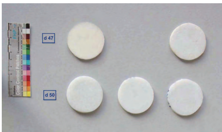
Abb. 33: Probekörper der d Massen, von links nach rechts: ohne UV-Bestrahlung, mit UV-Bestrahlung (polierter Probekörper), mit Uv Bestrahlung (Probekörper ohne Oberflächenbearbeitung)
