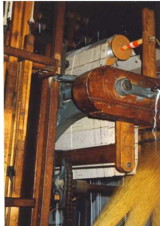
Abb. 13: Die Lochkartensteuerung der Jacquard-Maschine
