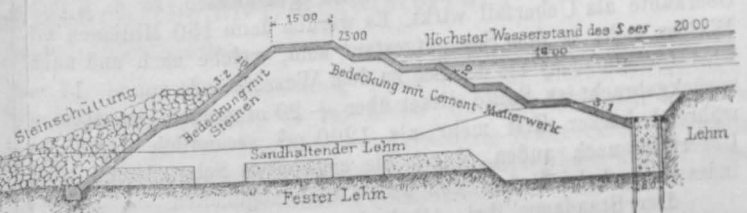
Fig. 10. Staudamm bei Bohio. 1:1000.
